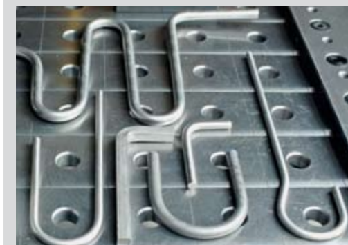
Kör keresztmetszet anyagok hajlításához 40 mm átmérőig
