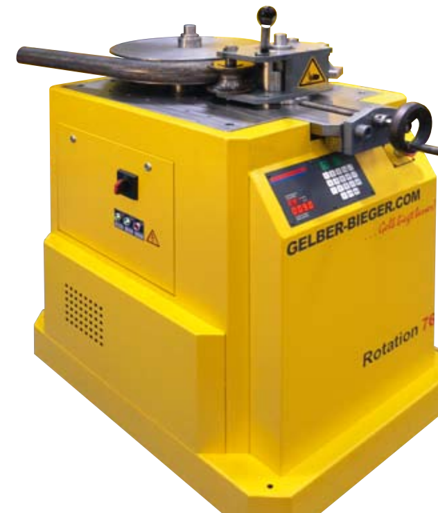
Kör keresztmetszet anyagok hajlításához 40 mm átmérőig
